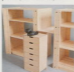
5 Для центрального шкафчика с ящиками также монтируют цокольную рейку и полку, закрепляя их через внутреннюю боковую стенку.
