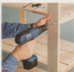
1 Монтаж фронтально открытого стоек производится на шуруты или мебельные винты с облагороженными головками.
